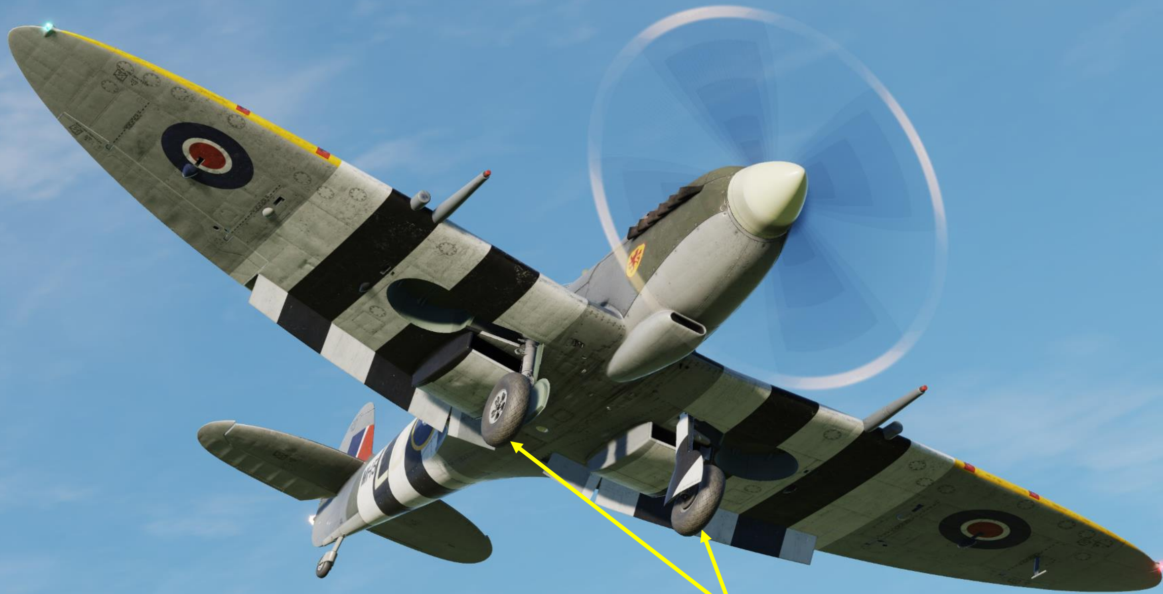
Přistávací podvozek (na obrázku spuštěný) Pneumaticky ovládané
